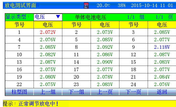
图 3.2.4 单体电压数据
